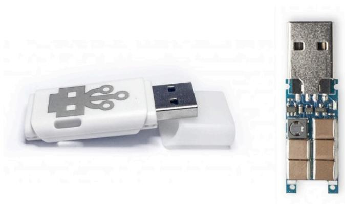
Гонконгская компания USBKill.com начала продажи флешки-убийцы USB Kill 2.0. Устройство способно сжигать электрическим разрядом в 200 вольт аппаратную часть самых разных устройств, оснащенных USB-портом. Бессильна флешка-убийца оказалась только перед последней версией MacBook.
